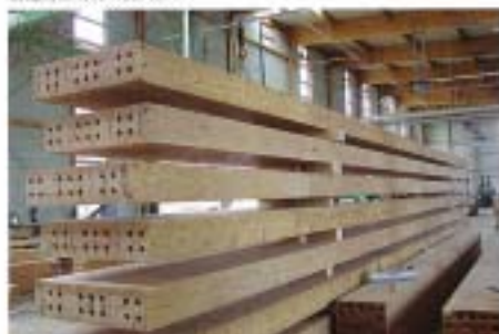
構造用集成材の孔穴加工
